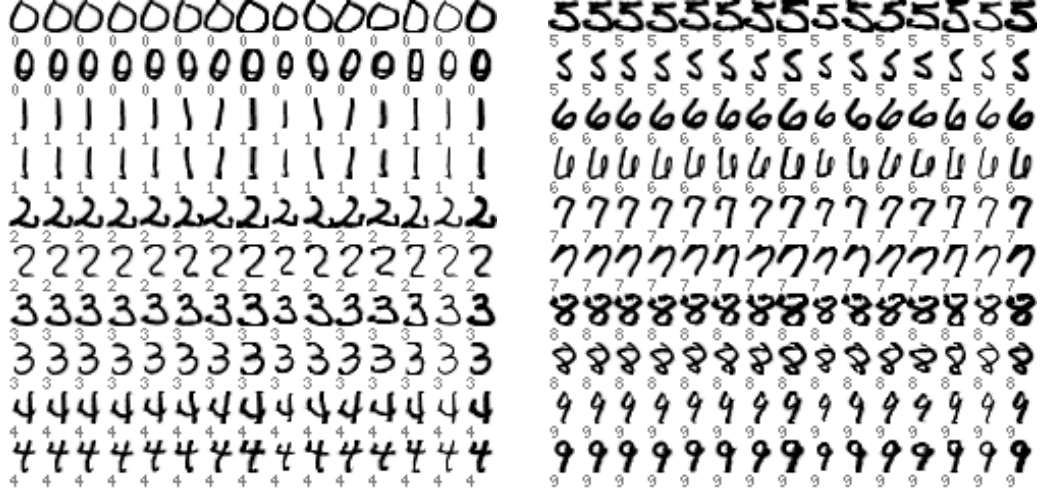
Abbildung 2.7: Beispiele für Variationen von USPS-Ziffern mit Hilfe der Tangentenapproximation. Links jeweils das Original, in den folgenden Spalten jeweils Variation in negative und positive Richtung der Tangenten für horizontale Translation, vertikale Translation, Rotation, Skalierung, Achsendeformation, diagonale Achsendeformation und Strichdicke. Als Vorfaktoren für die Tangenten in (2.55) wurde bei den Translationen -0.5, 0.5, bei den übrigen -0.2, 0.2 verwendet.
